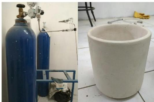
Gambar 2.3 tabung gas argon dan tungku *furnace* dari bahan keramik
