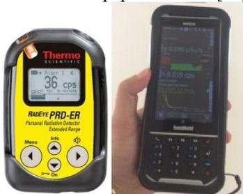
Gambar 1a dan 1b. Personal Radiation Detector (PRD) dan Portable Radiation Scanner (PRS) bagian dari backpack
