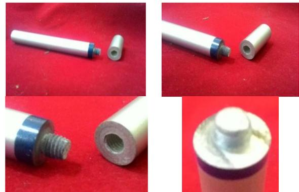
Gambar 2. Sumber Standar  $^{57}\text{Co}$  Bentuk Rod
